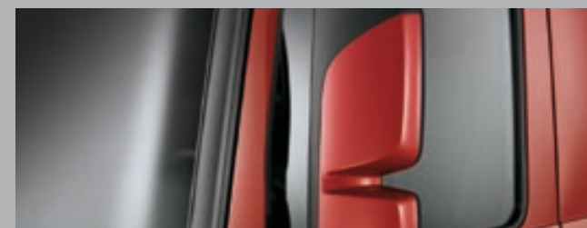
Наружные зеркала надежно защищены от вибрации и дольше остаются чистыми благодаря своей конструкции, предотвращая также загрязнение бортов автомобиля. На заказ они предлагаются в исполнении из двух частей, одна из которых может быть хромированной, окрашенной в цвет кабины либо усиленной.
